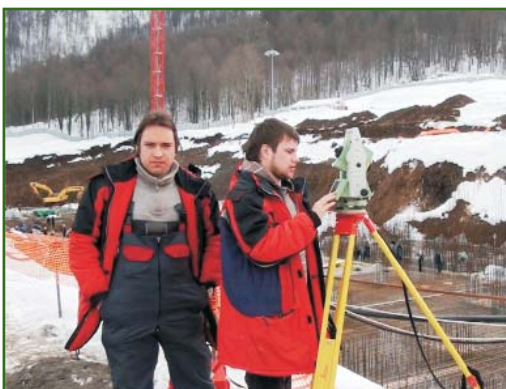
Инженеры-геодезисты работают с тахеометром Leica TPS1200+
